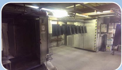
Pulverkabine mit Laufband und Brennofen (eine unserer sechs Produktionsstraßen)
