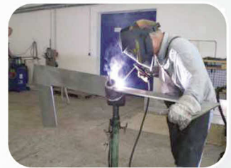
Elektro Handschweiß Verfahren
